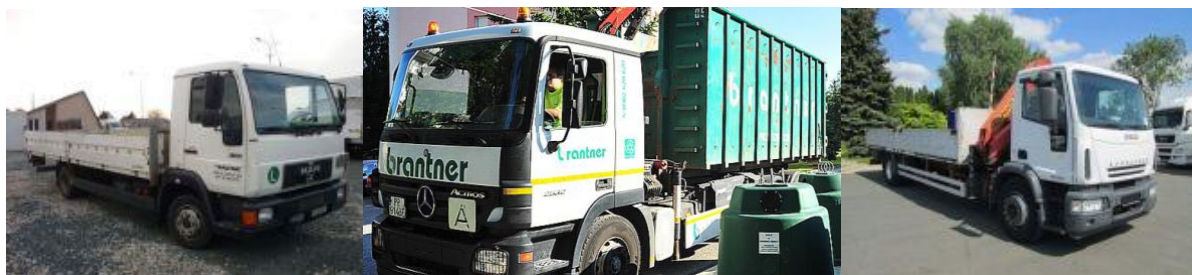
Obr. 14: Valník do 3,5 t – zber vriec, valník s hydraulickou rukou, hákové vozidlo s hydraulickou rukou napr. na výsyp zvonov so sklom
