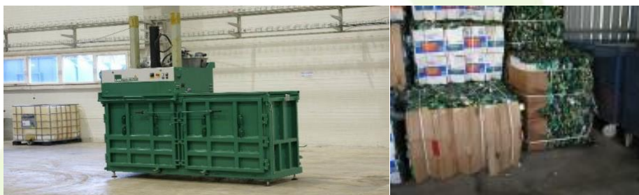
Obr. 17: Dvojkomorový balíkovací lis využívaný na úpravu menších množstiev papiera a plastov v menších regionálnych zberových spoločnostiach
